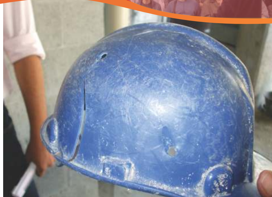
Capacete de trabalhador atingido por objeto. Plataformas e telas são fundamentais para a segurança
